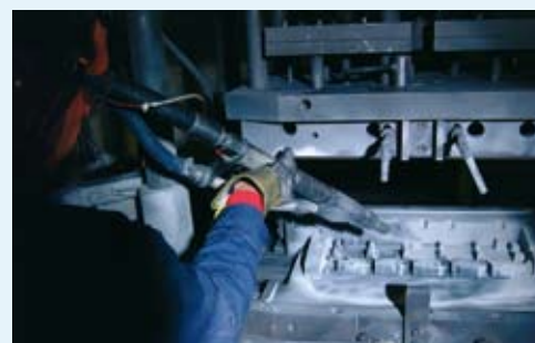
Usuwanie powłoki tlenku glinu z matrycy w temperaturze 300°C
